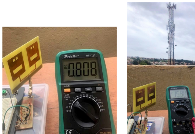
Figura 21: Voltaje obtenido y localización del sistema, presencia directa de fuentes de radiofrecuencia
