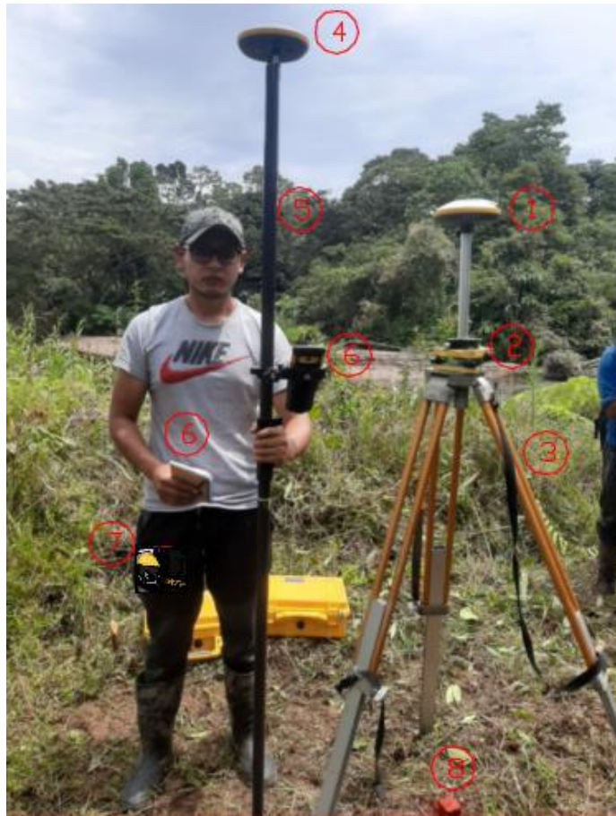
Figura 4. Equipos y materiales utilizados en el levantamiento con GPS Diferencial- Receptor base (1), Base nivelante (2), Trípode (3), Receptor móvil (Rover) (4), Bastón (5), Colectora (6), Libreta de campo (7), Punto estático (estaca) (8), Flexómetro (9)
