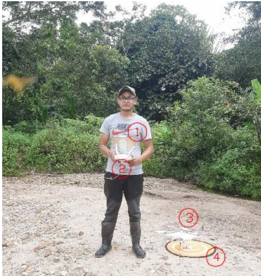
Figura 5. Equipo empleado en el levantamiento aerofotogramétrico – Tablet (1), Control remoto (2), Dron (3), Pista de aterrizaje y despegue (4)
