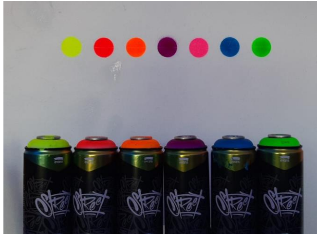
Figura N° 6. Prueba de tonos fluorescentes en aerosol aplicados sobre pared.
