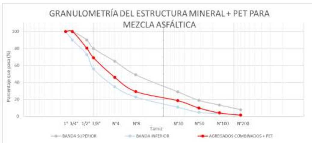
Figura 19. Curva granulométrica de la estructura mineral + PET para mezcla asfáltica
