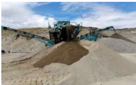
Figura 2. Trituración y cribado del material pétreo procedente de Guamote
