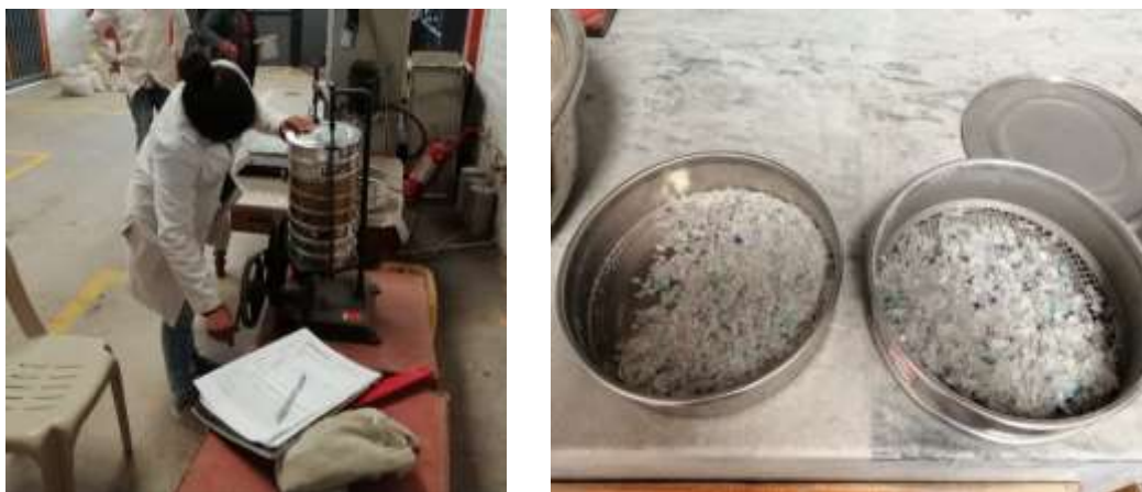
Figura 16. Granulometría del material pétreo y PET
