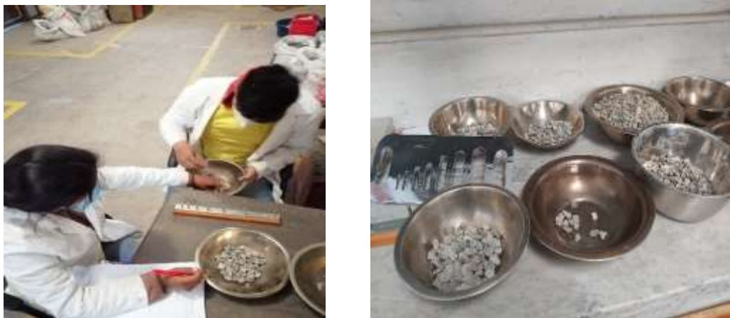
Figura 43. Partículas planas y alargadas del material pétreo
