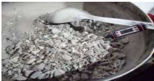
Figura 12. Agregados pétreos + PET para mezcla asfáltica
