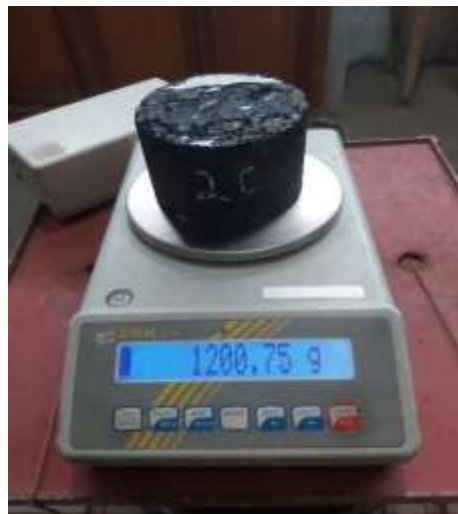
Figura 46. Pesos y medidas de la Gravedad específica BULK
