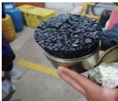
Figura 30. Briqueta con exceso de plástico
