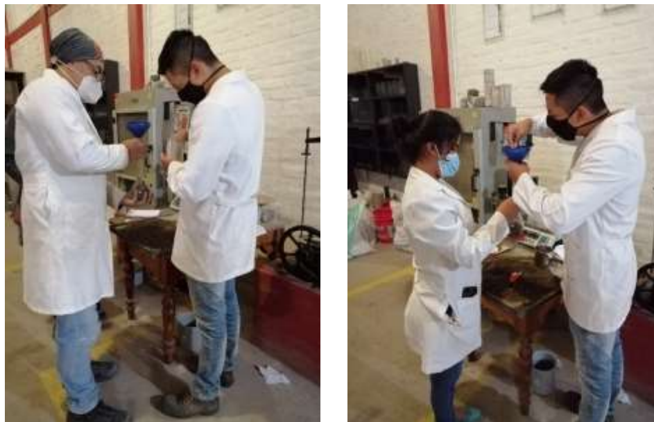
Figura 39. Peso específico del material pétreo
