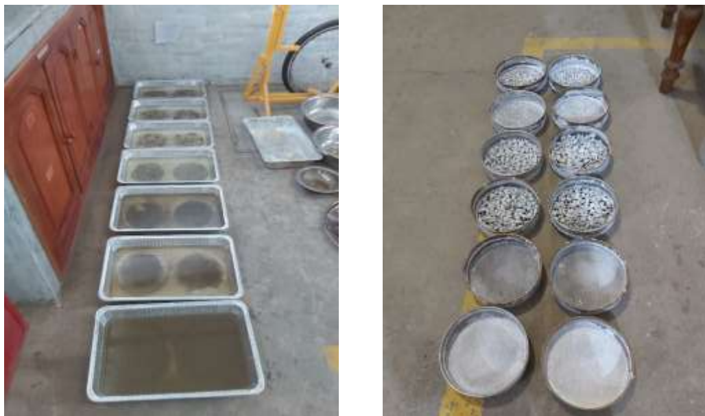
Figura 44. Resistencia a los sulfatos de los agregados pétreos
