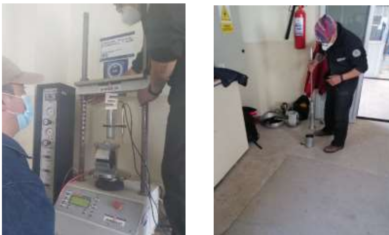
Figura 18. Estabilidad y Flujo - Marshall
