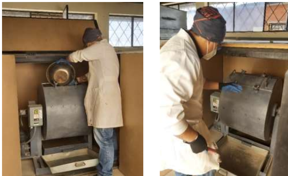
Figura 41. Abrasión o desgaste de los agregados
