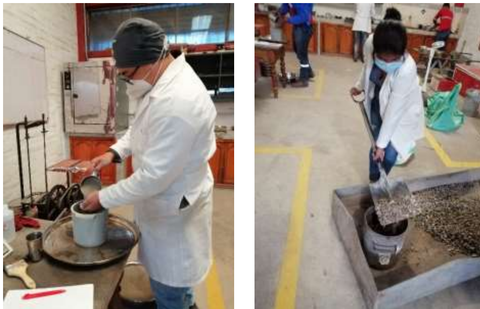
Figura 40. Masas unitarias sueltas y compactas del material pétreo
