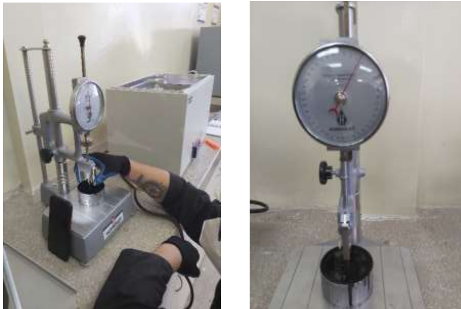
Figura 14. Penetración del ligante bituminoso
