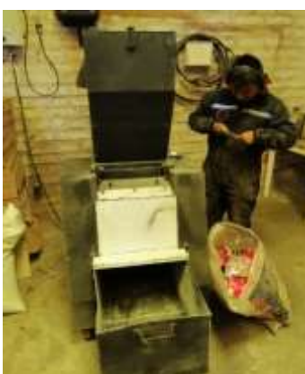
Figura 8. Proceso mecánico de trituración del PET
