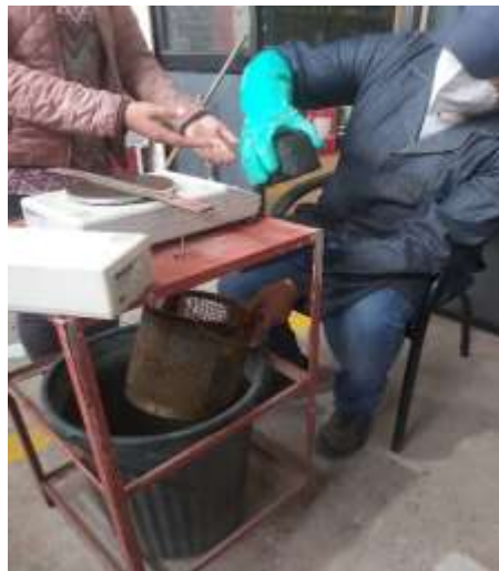
Figura 46. Pesos y medidas de la Gravedad específica BULK
