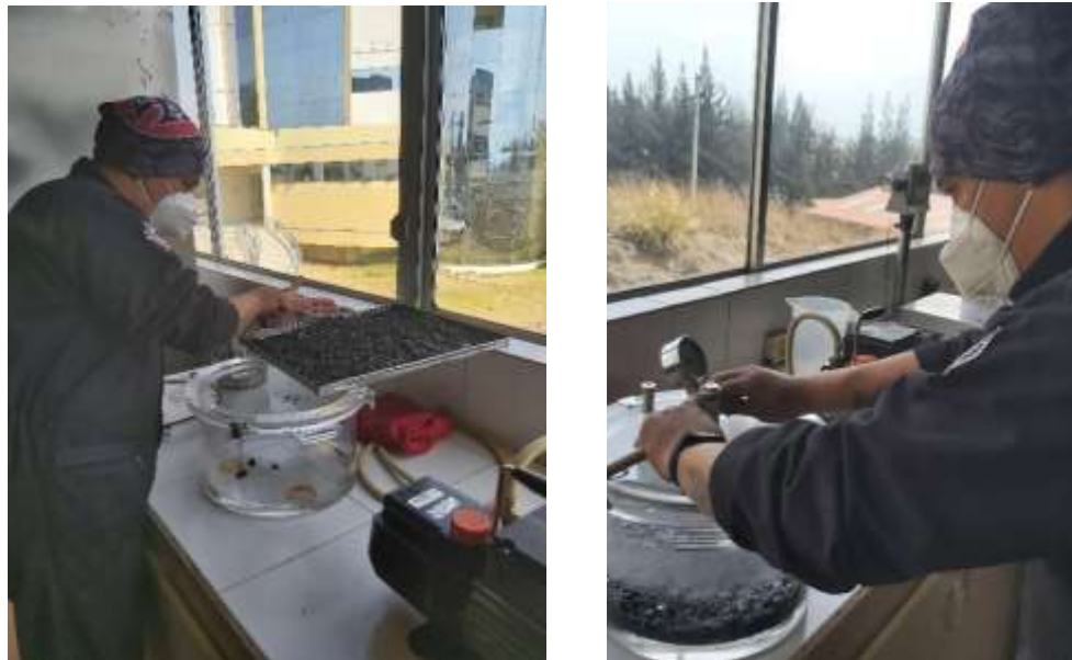
Figura 45. Ensayo para la obtención del porcentaje de vacíos
