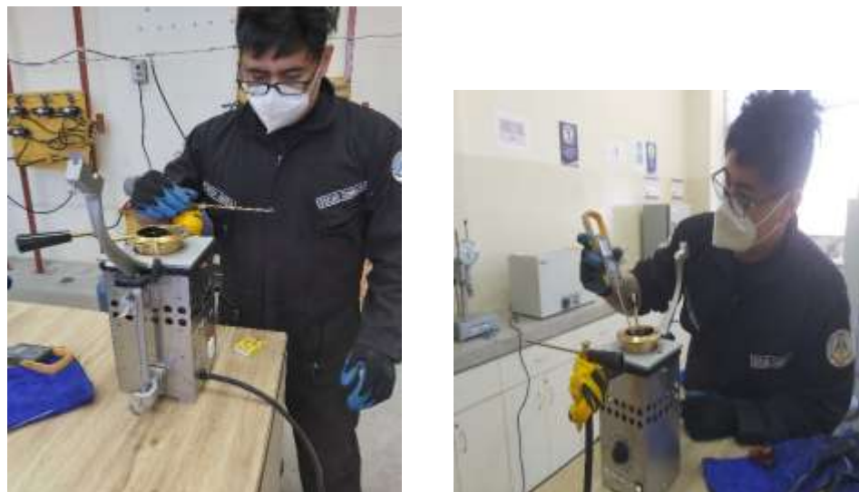
Figura 15. Punto de inflamación del ligante
