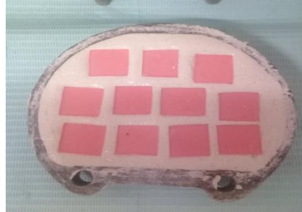
Figura Nro. 4: Moldes de cera sobre yeso tipo II
