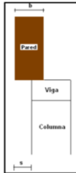
Ilustración 4. Saliente s entre la mampostería y el pórtico Fuente: (Aguiar & Bolaños, 2006)
