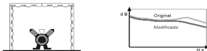
Figura 12: Encerramiento con materiales livianos
