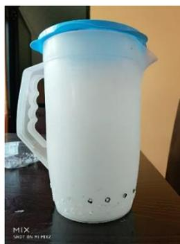
Ilustración 7 Recipiente perforado para agitar los piroclastos
