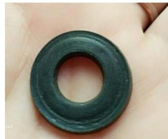
Ilustración 10, Caucho hermético para la unión de mangueras y llaves.
