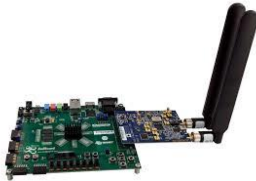
Figura 25. SDR conformado por las tarjetas Zedboard y AD-FMCOMMS4-EBZ.
