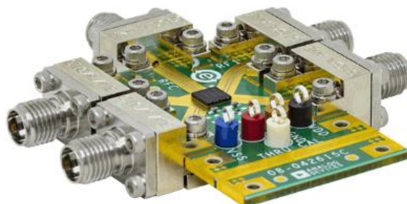
Figura 19. Conmutador de RF.
