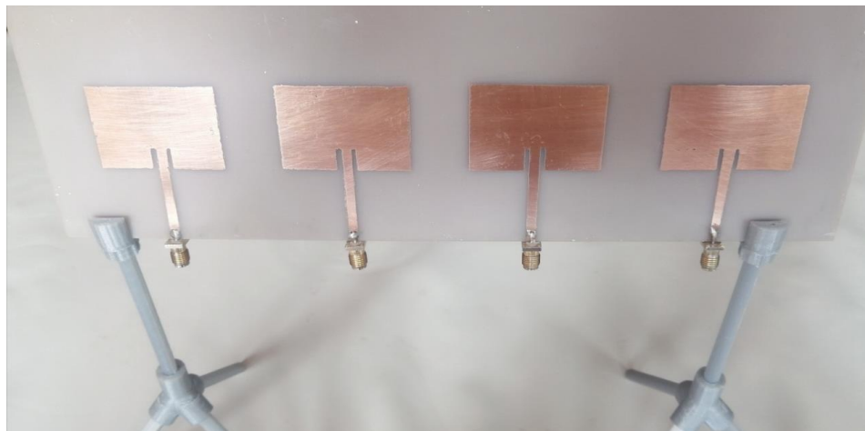
Figura 50. Agrupación lineal uniforme de cuatro antenas implementada.
