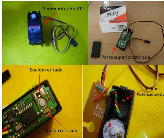
Figura 19. Servomotor Truncado
