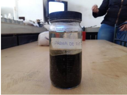
Fotografía 7: Colorimetría de la arena de río de la mina Hormigones Moreno
