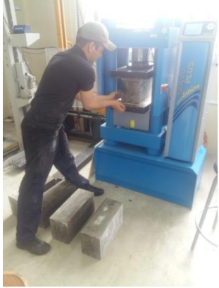
Fotografía 15: Realización de los ensayos de compresión simple
