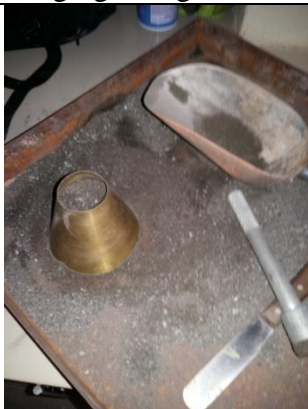
Fotografía 5: Ensayo de densidad y porcentaje de absorción de la arena de río de la mina Hormigones Moreno
