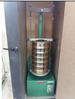
Fotografía 4: Ensayo granulométrico de la arena de río de la mina Hormigones Moreno
