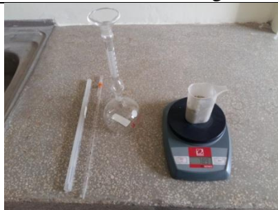
Fotografía 6: Ensayo de densidad del cemento Chimborazo
