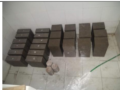
Fotografía 14: Colocación de las probetas en la piscina de curado y llenado de agua de la misma
