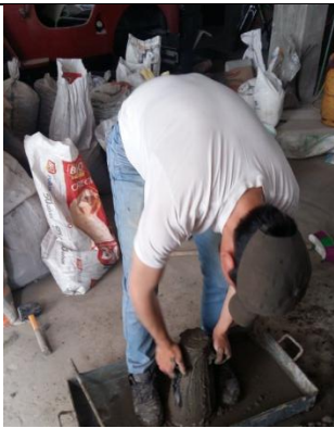
Fotografía 11: Determinación del asentamiento del hormigón
