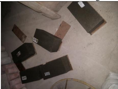
Fotografía 13: Desmoldado de las probetas de hormigón
