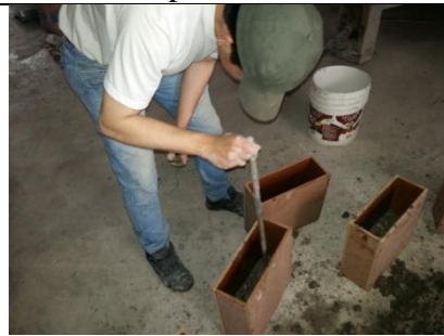
Fotografía 12: Varillado del hormigón en los moldes de MDF
