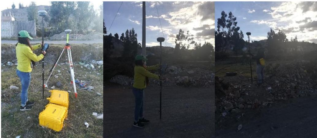
**Figura 21.** Topografía terrestre con sistema de posicionamiento global (GPS) estacionario, pruebas volumétricas de pila de residuos de construcción
