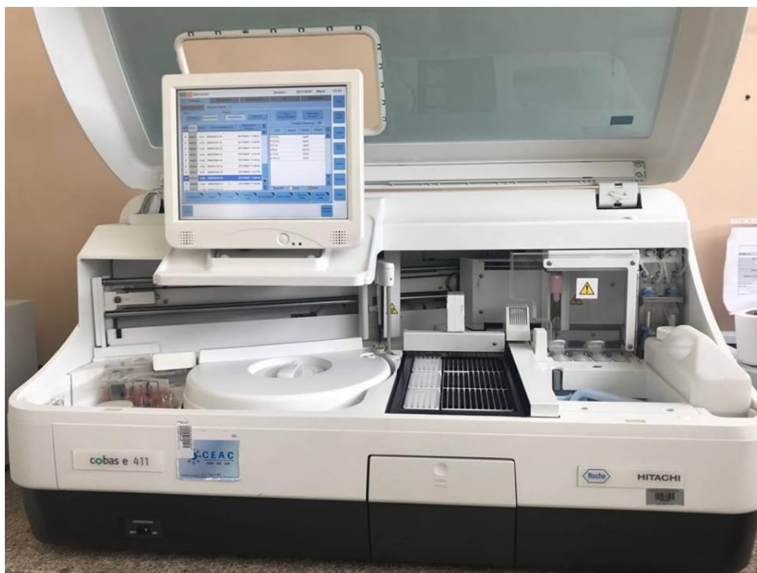
Evidencia Fotográfica 2: Equipo Cobas e 411, para la determinación de Ferritina
