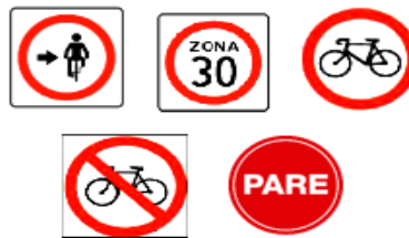
Señales regulatorias para la ciclovía
