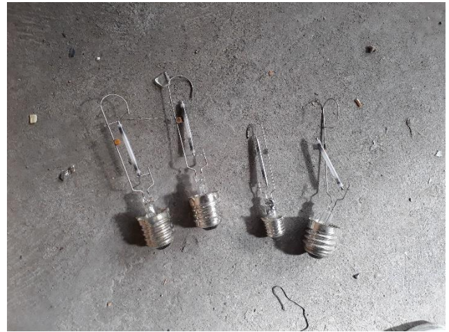
Focos de Na rotos
