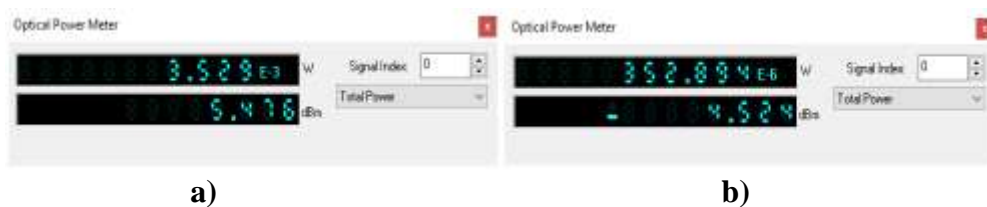
Figura 21. Niveles de potencia óptica: a) Salida Transmisor. b) Salida Receptor.
