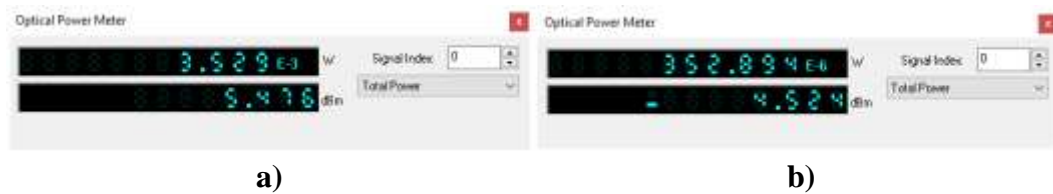
Figura 16. Niveles de potencia óptica: a) Salida Transmisor. b) Salida Receptor.
