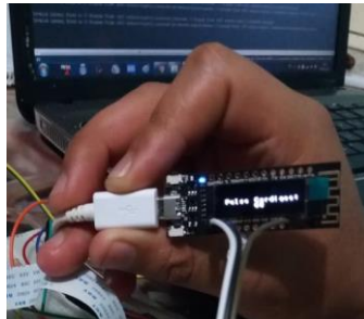
Figura 19. Conexión del ESP8266 TTGO a la PC con cable USB
