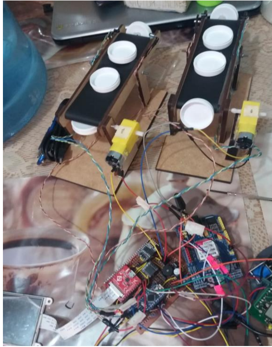
Figura 43. Elaboración del sistema de posología, y envío de SMS de emergencia
