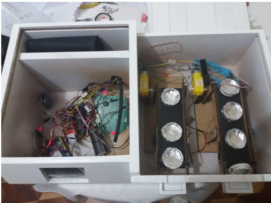
Figura 44. Implementación de todos los módulos en el chasis
