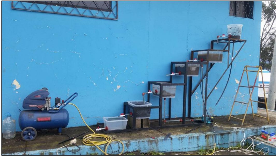
Figura 1. Prototipo de la planta de tratamiento
