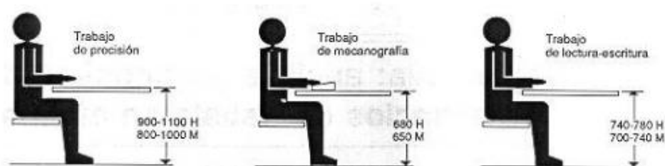
Gráfico N. 5.13 Altura del plano de trabajo para puestos de trabajo sentado (cotas en mm)
