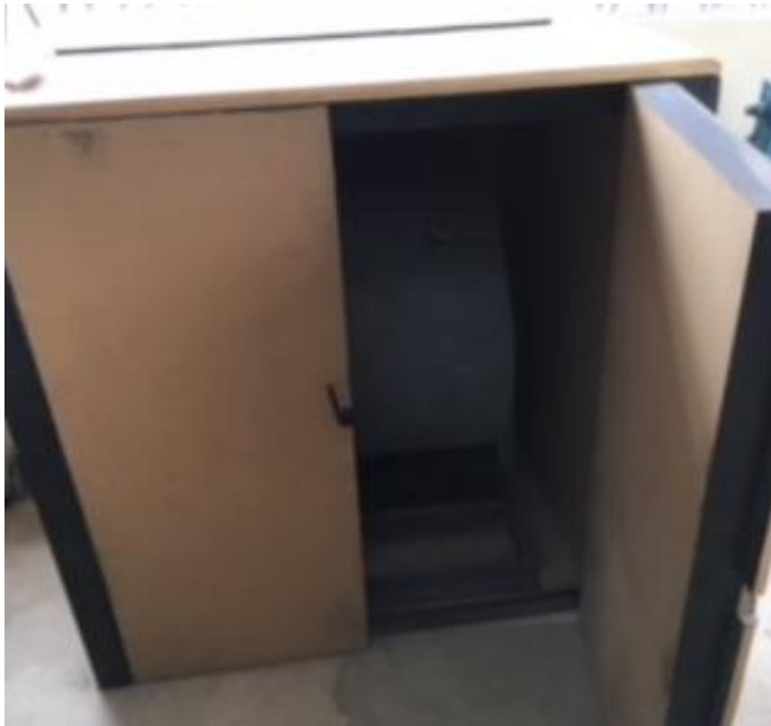
Ilustración 3.7.3- Cabina de insonorización.
