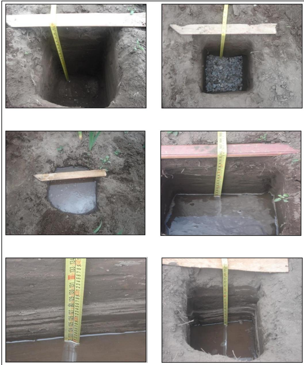
**Figura 18:** Ensayo de infiltración para la planta de tratamiento.
