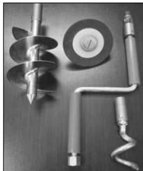
**Gráfico 1.** Accesorios para limpieza, usados conectados a varillas de acción mecánica.
