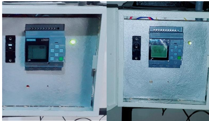
Figura 25. Visualización de la fecha y programación cargado en el LOGO8! Fuente: Autor
