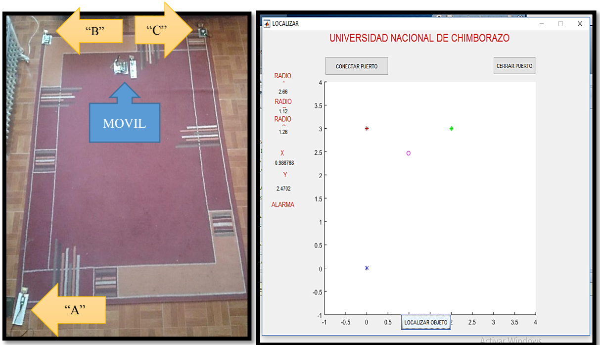
Figura 53. Prueba con el sensor móvil en la parte superior. Fuente. Autor
