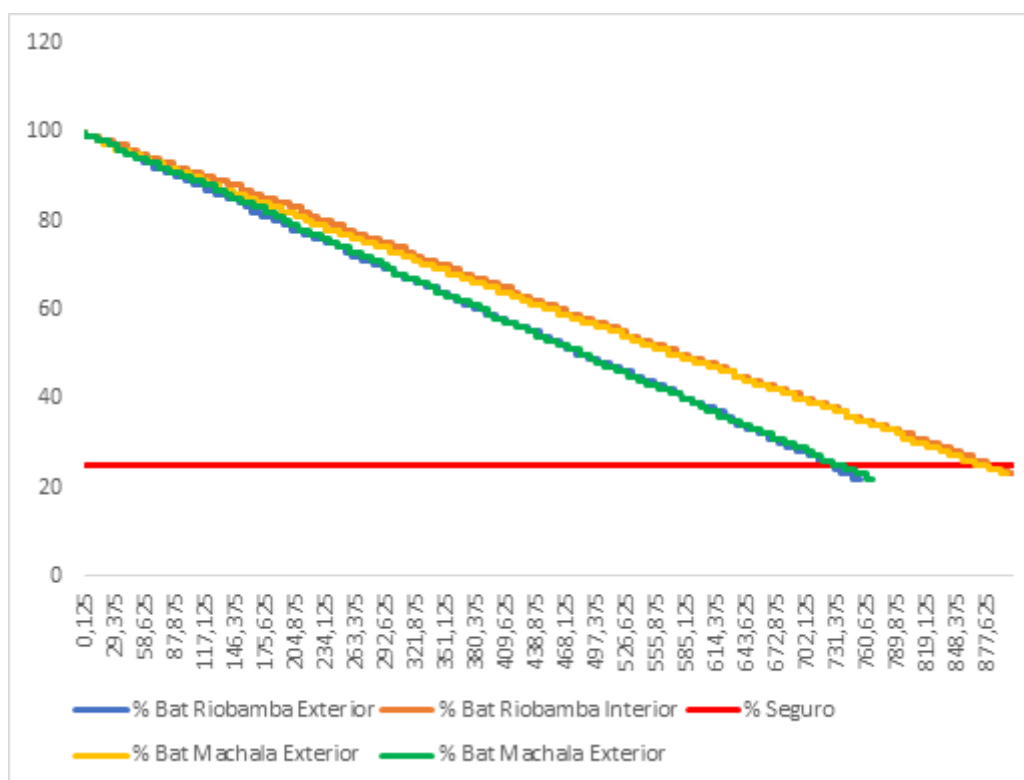
Figura 33. Pruebas de autonomía de la batería Fuente Autor
