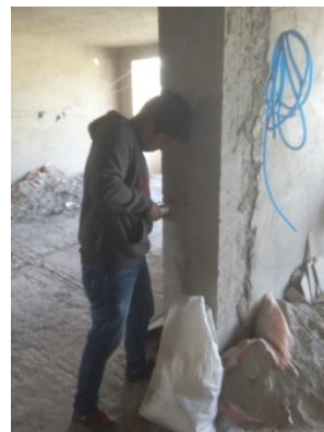
Ilustración 5. Toma de datos esclerómetro
