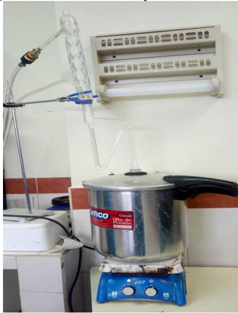
Figura 3. Método de arrastre por corriente de vapor
