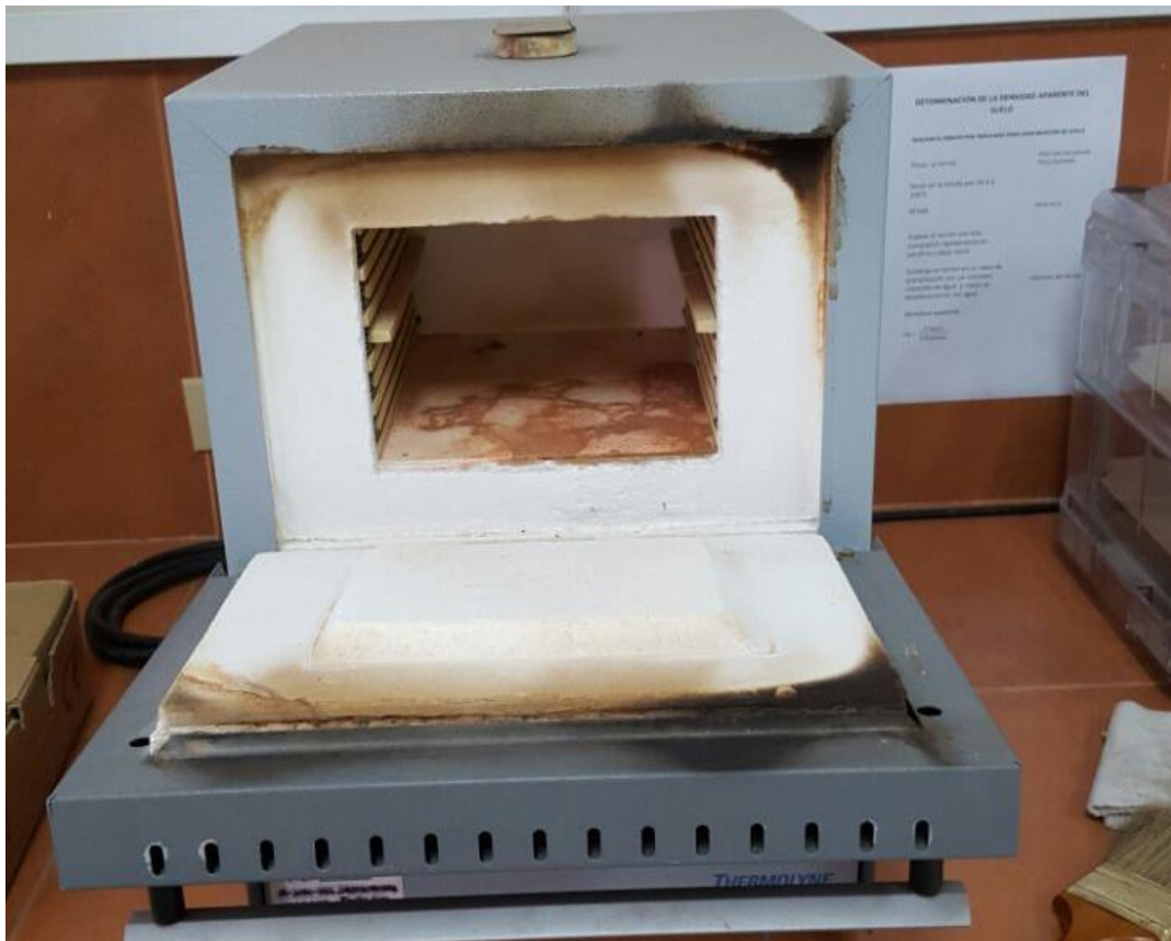
FOTOGRAFÍA N°09. Colocar en la mufla por 2 horas a 450°C Fuente: Autores
