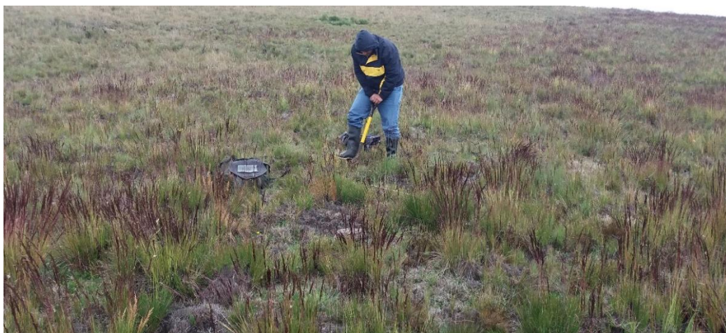
FOTOGRAFÍA N°02. Elaboración de calicatas.
