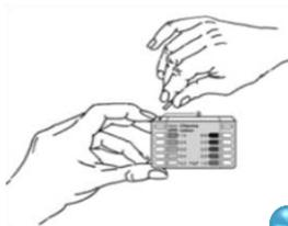
Colocar una tableta en la cámara de prueba (a), añadir unas gotas del suministro de agua que se va a analizar.
