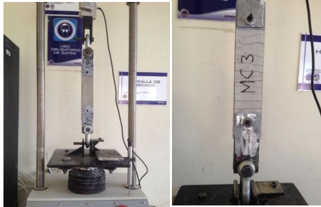
Figura 4. Ensayo de tracción de material compuesto FRCM reforzado con tejido de saco y tejido diseñado.
