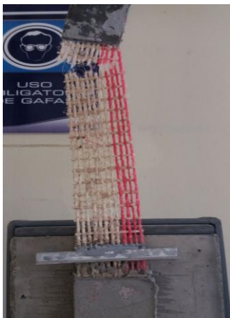
Figura 10. Ensayo SLS: Falla del tejido fuera del material compuesto reforzado con tejido diseñado.
