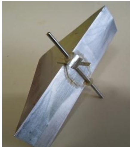
Figura 33. Báscula del Pluviómetro.
