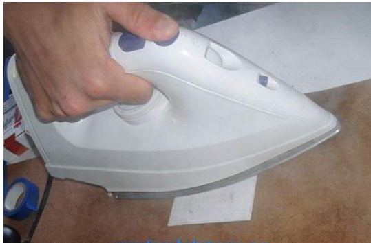
Figura 22. Transferencia del diagrama electrónico a la placa de cobre.
