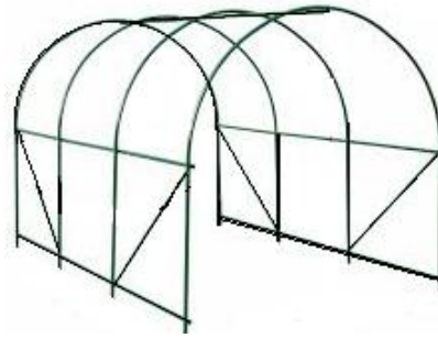
Figura 1. Invernadero tipo Túnel. Fuente: Autor.
