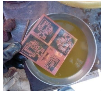
Figura 26. Colocación de la placa en el Acido.
