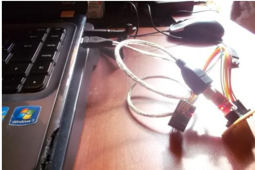
Figura 104. Conexión al Puerto USB del Grabador de Módulos WIFI.
