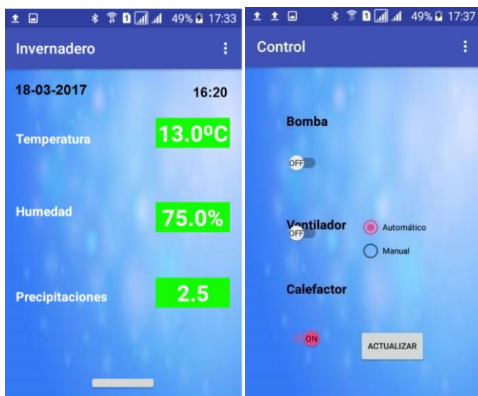
Figura 135. Encendido del Calefactor Aplicación Android.
