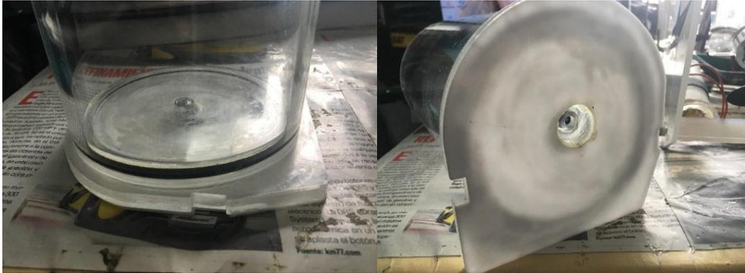
**Figura 9.** Mecanismo de impermeabilización y alivio de presión.
