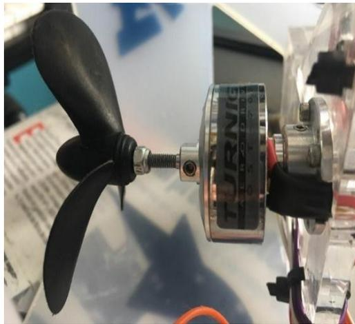
**Figura 11.** Actuadores (Motores Brushless Turnigy).
