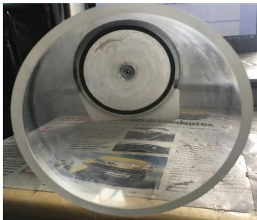
**Figura 10.** Espesor del casco de compresión.
