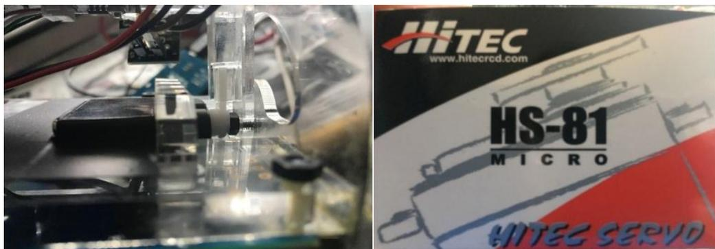
**Figura 14.** Micro servo motor de 2.6Kg.
