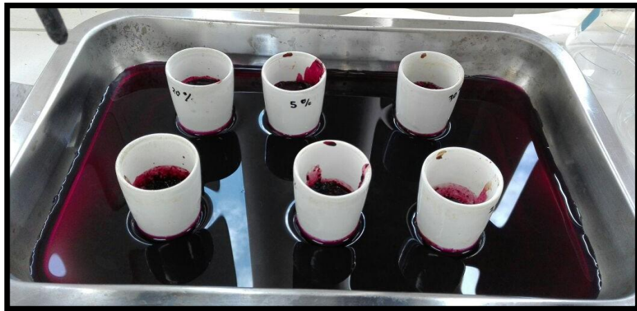
Figura 5. Método de Permanganato para obtención de Lignina
