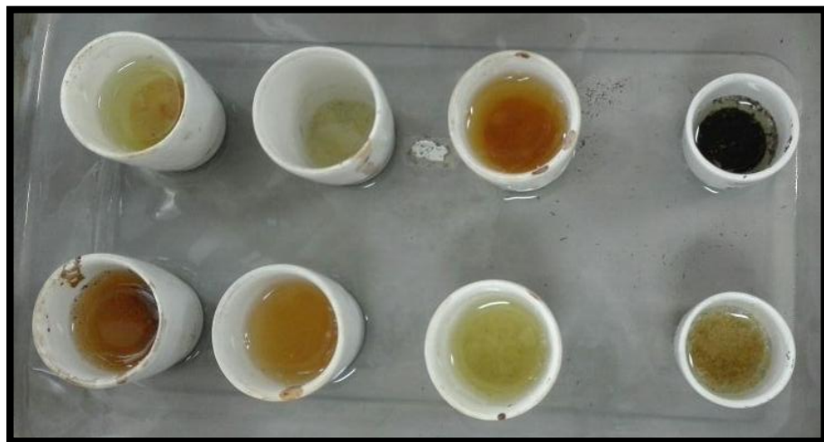
Figura 5. Método de Permanganato para obtención de Lignina
