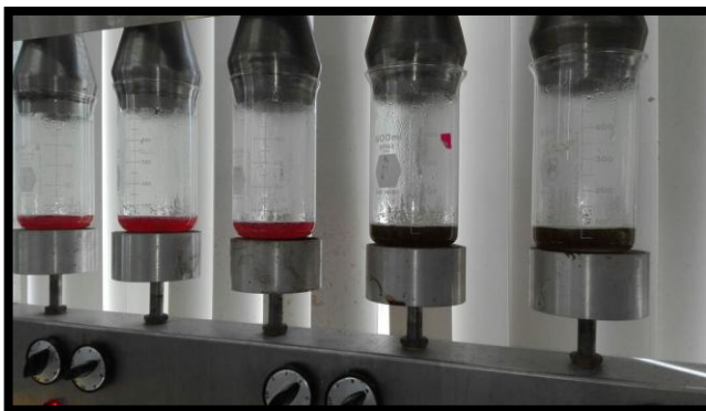
Figura 1. Análisis Fibra Detergente Neutro (FDN); Fibra Detergente Ácido (FDA).
