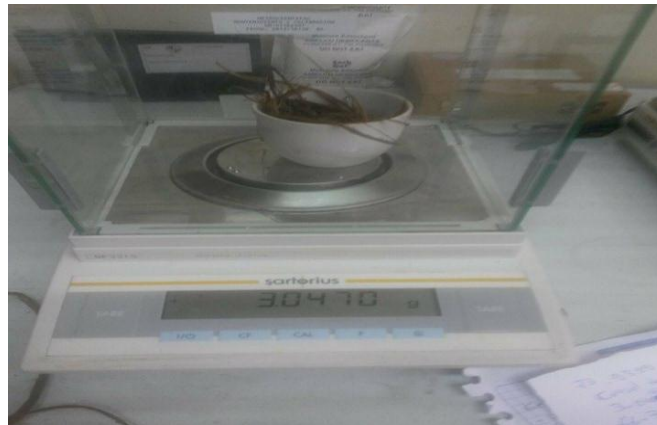
Figura 6. Determinación del porcentaje de humedad de la fibra
