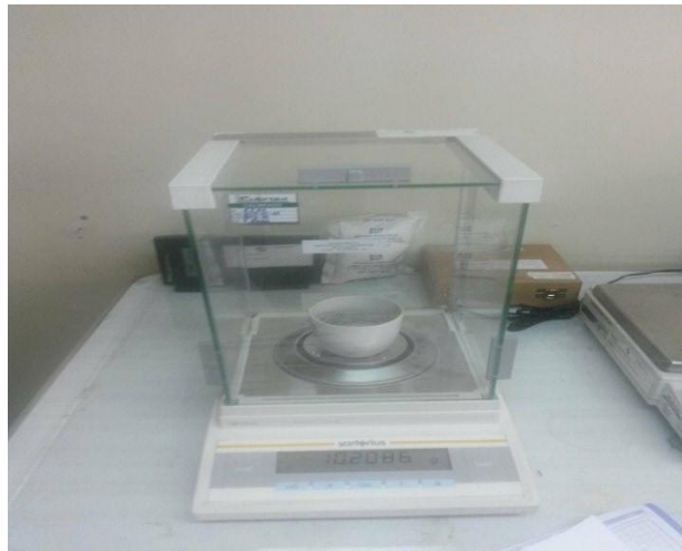
Figura 5. Peso del crisol tarado con 3 gramos de muestra
