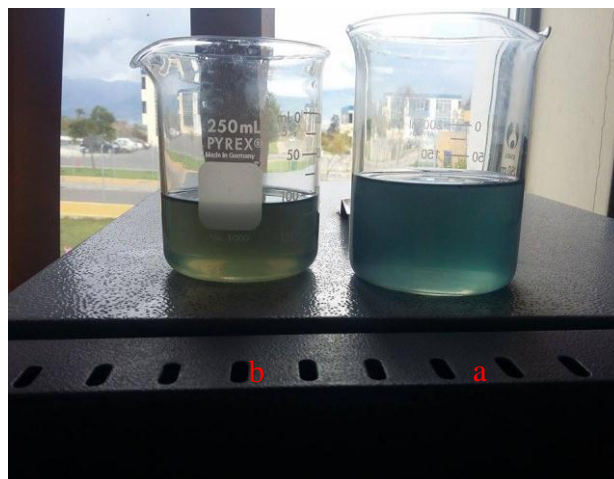
Figura 19. a) muestras del agua residual. b) agua tratado por el lecho filtrante
