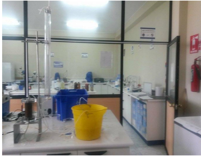
Figura 10. Determinación de la permeabilidad de la fibra
