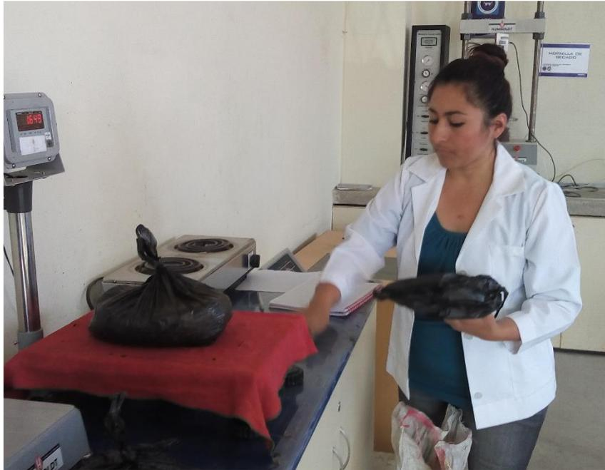
*Fotografía 12: Obtención del peso de la muestra.*
