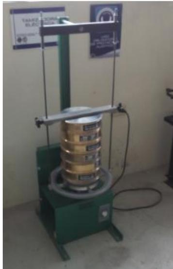
**Fotografía 4:** Ensayo de Granulometría.
