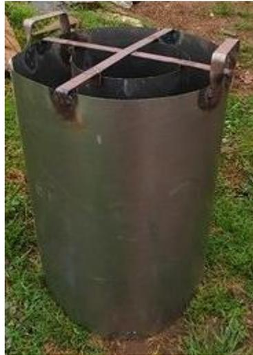
*Fotografía 1: Infiltrómetro de Cilindro Doble.*
