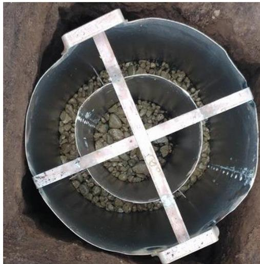
*Fotografía 3: Ensayo de Infiltración.*
