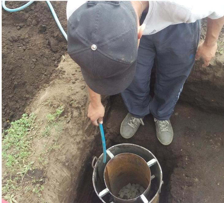
**Fotografía 10:** Colocación de agua en cilindro, calicata N° 3, Comunidad Tiquibuzo.
