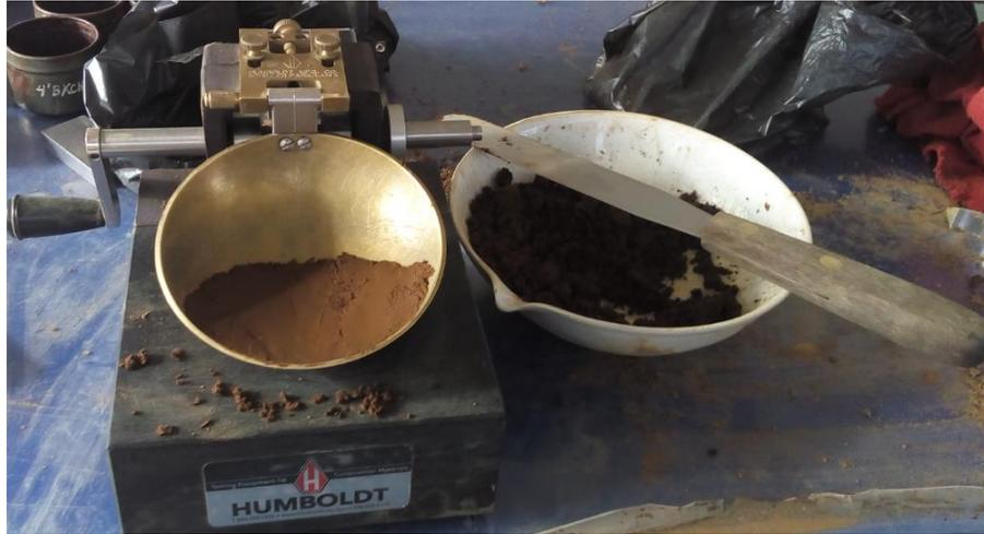
*Fotografía 5: Ensayo Límite Líquido.*
