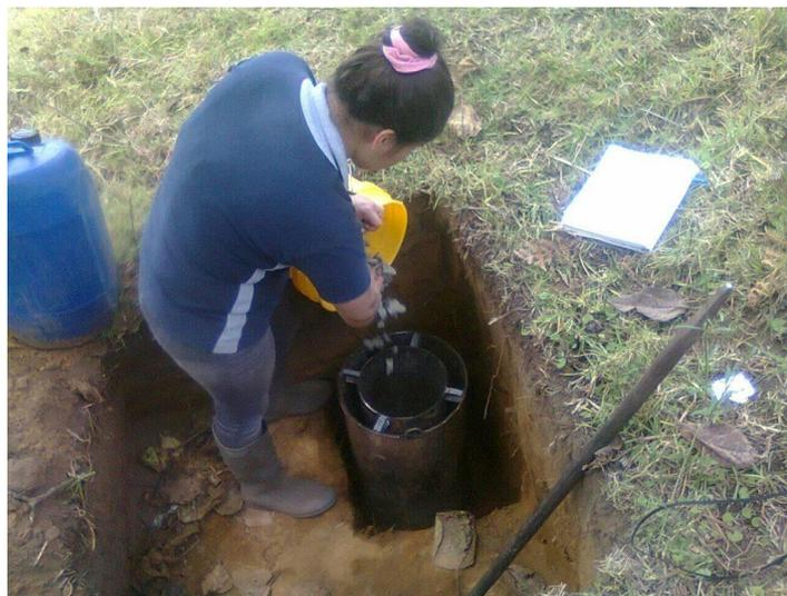
*Fotografía 7: Colocación de agregado de  $\frac{3}{4}$ " , con un espesor de 5 cm, calicata N° 5, Comunidad San José de la Comuna.*
