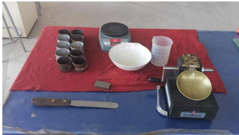
**Fotografía 17:** Materiales para Ensayo de Limite Liquido.
