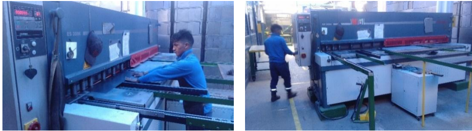
Figura 24 Proceso de corte de lámina metálica
