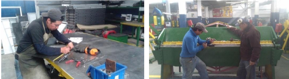
Figura 25 Proceso de doblado de la lámina metálica
