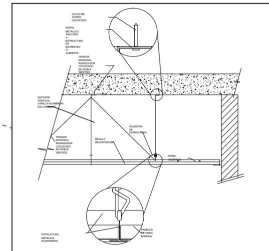
**SUJECIÓN DE CIELO RAZO CON LA LOSA**
