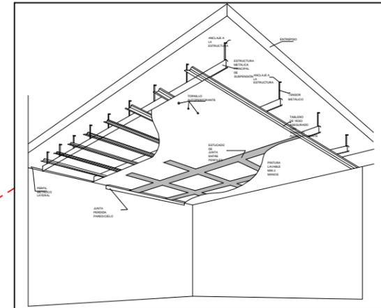
**AXONOMETRIA DE ARMADO DE CIELO RAZO FALSO**
