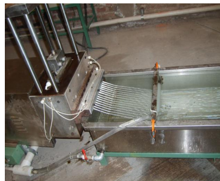
Figura N° 7.11. Bandeja de enfriamiento
