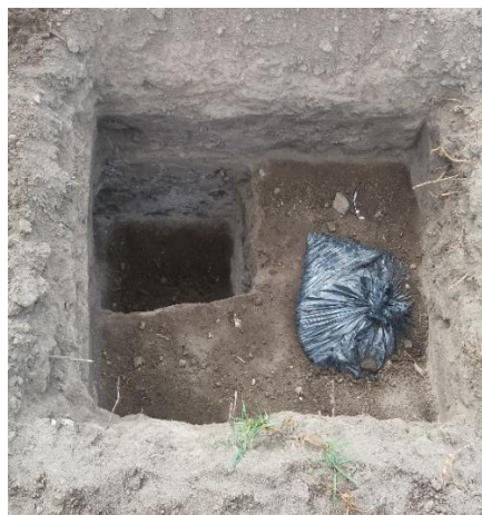
Fotografía 2 Calicata de ensayo
