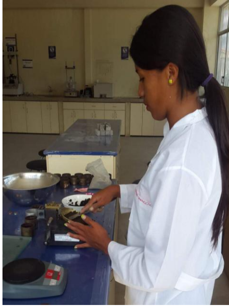
Fotografía 5 Ensayo de Límite Líquido
