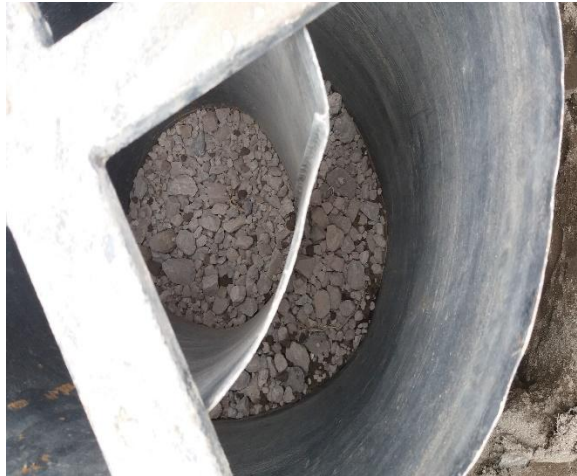
Grava en el fondo del infiltrómetro
