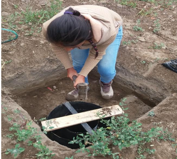
Hincado del infiltrómetro doble con la ayuda de un combo y una tabla
