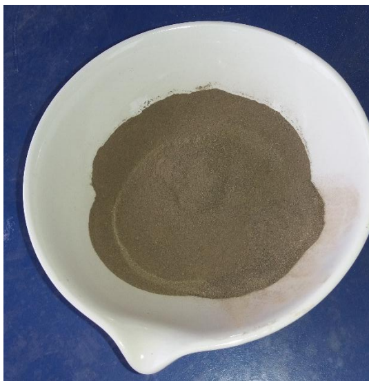
Selección del material que pasa el tamiz N° 40 para los Límites de Atterberg
