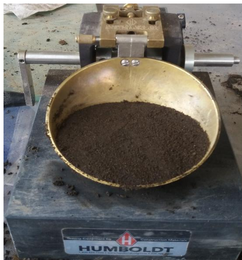
Ubicación del material en la Copa de Casagrande
