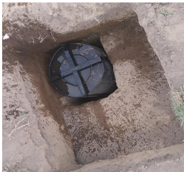
Infiltrómetro lleno de agua
