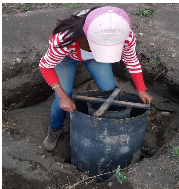
Ubicación del infiltrómetro en la calicata de ensayo
