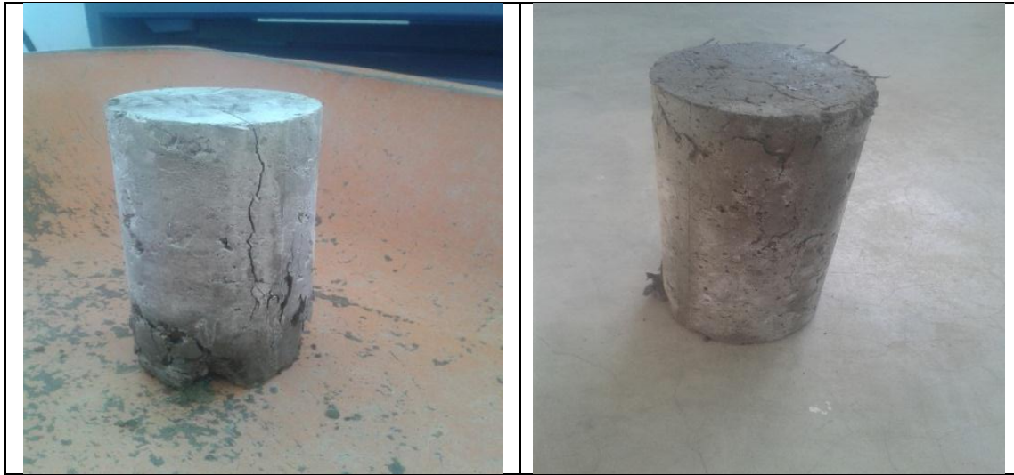
Ilustración 52.- Falla tipo 2 Hormigón Modificado.
