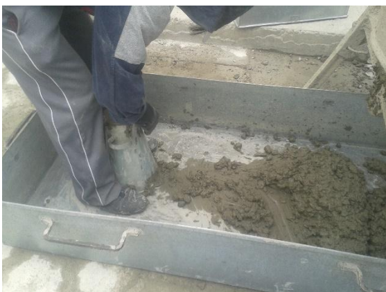
Ilustración 12.- Verificando la consistencia del hormigón mediante el cono de Abrams.
