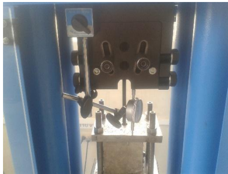
Ilustración 29.- Forma de colocación del deformímetro.
