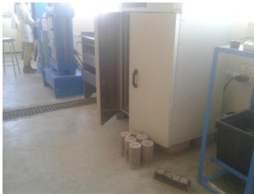
Ilustración 22.- Retirando los especímenes del horno.
