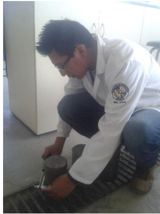
Ilustración 21.- Determinando las dimensiones del espécimen utilizando un tornillo micrométrico.
