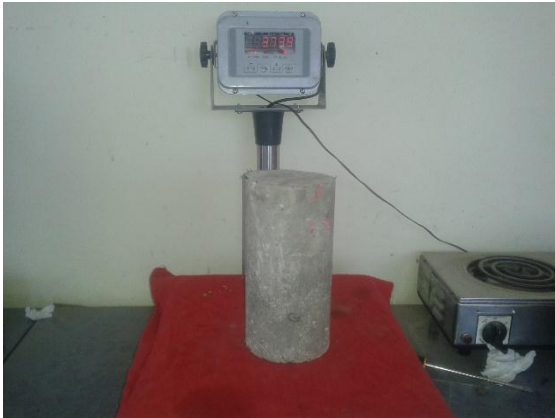
Ilustración 20.- Determinando la masa inicial del espécimen para posteriormente determinar la masa saturada después de ebullición en agua.
