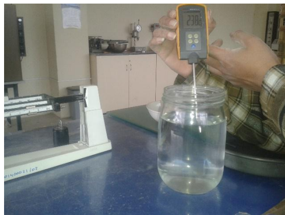
Ilustración 8.- Proceso para determinar la densidad SSS de los áridos.
