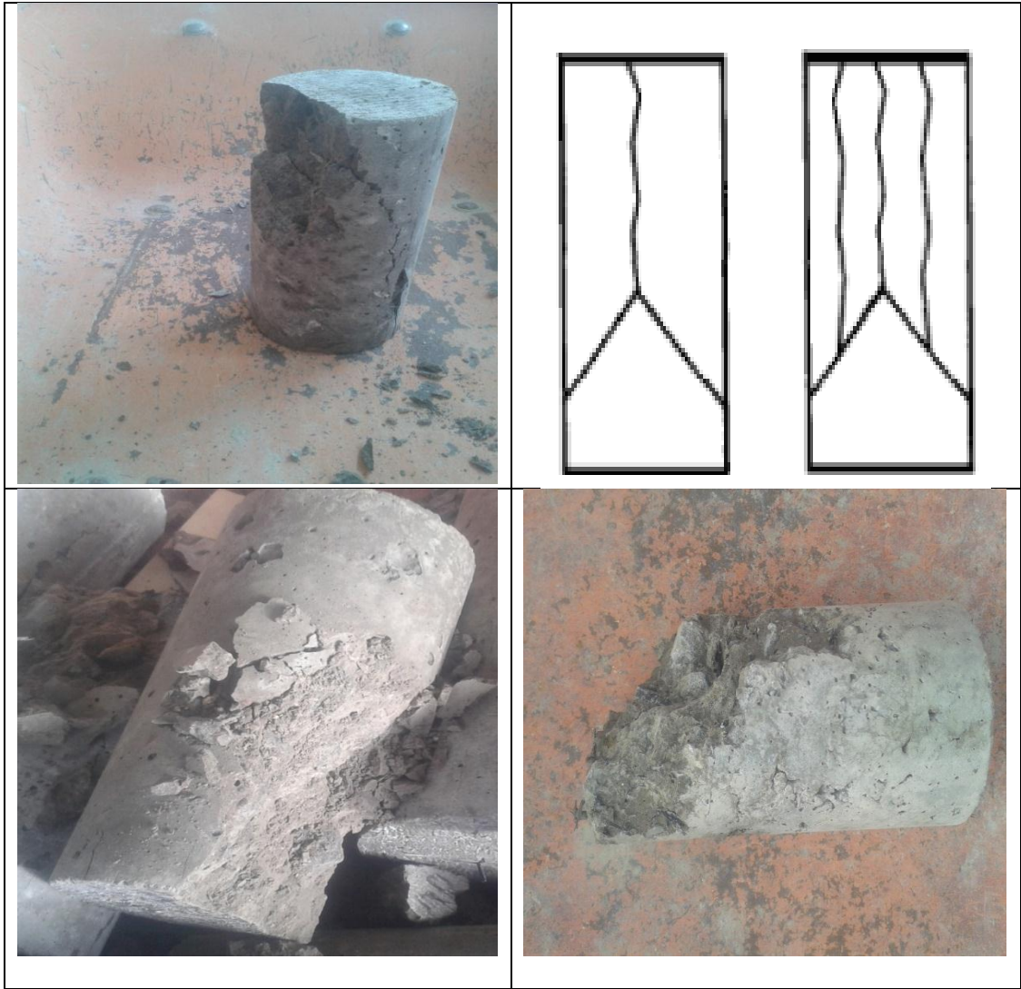
Ilustración 51.- Falla tipo 2 Hormigón Convencional.
