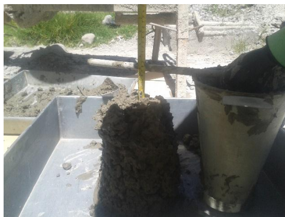
Ilustración 12.- Verificando la consistencia del hormigón mediante el cono de Abrams.
