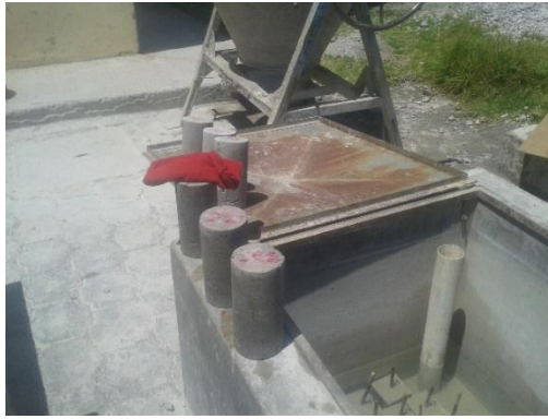
Ilustración 23.- Removiendo con franela la humedad superficial de los especímenes.
