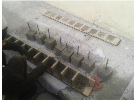
Ilustración 24.- Limpiando los moldes para proceder a fundir las probetas cúbicas.
