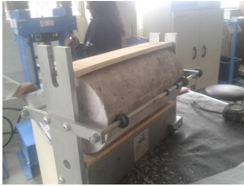
Ilustración 16.- Colocación del espécimen en el molde, para alineación de cilindros de hormigón y tiras de carga.
