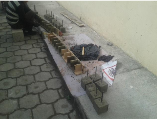
Ilustración 24.- Limpiando los moldes para proceder a fundir las probetas cúbicas.
