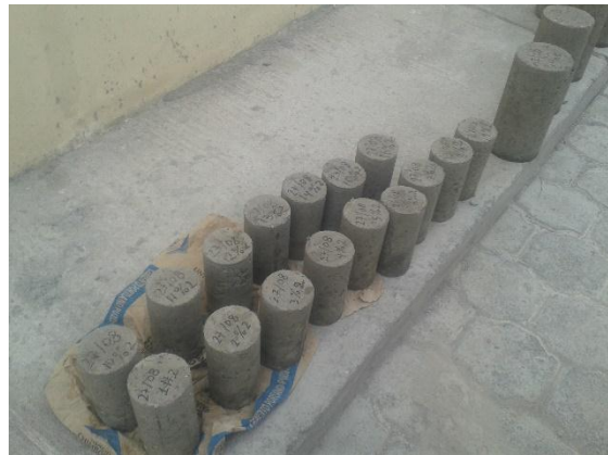
Ilustración 11.- Elaboración del hormigón y marcado de los especímenes para su identificación
