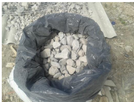
Ilustración 32.- Ripio triturado después del tamizado.
