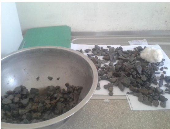
Ilustración 8.- Proceso para determinar la densidad SSS de los áridos.
