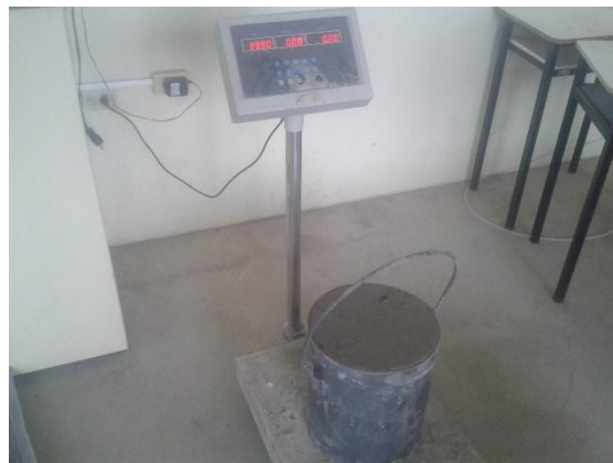
Ilustración 13.- Colocación del hormigón en el recipiente de medición y pesaje del mismo.
