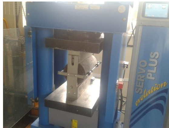
Ilustración 15.- Posición del espécimen en la máquina de ensayo para determinar la resistencia a tracción por compresión diametral. Fuente: (Concreto, 2009)
