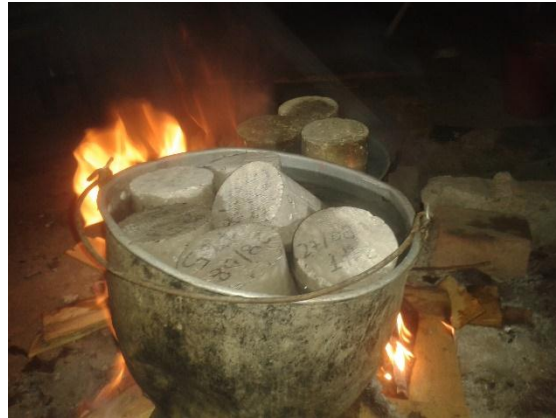
Ilustración 20.- Determinando la masa inicial del espécimen para posteriormente determinar la masa saturada después de ebullición en agua.
