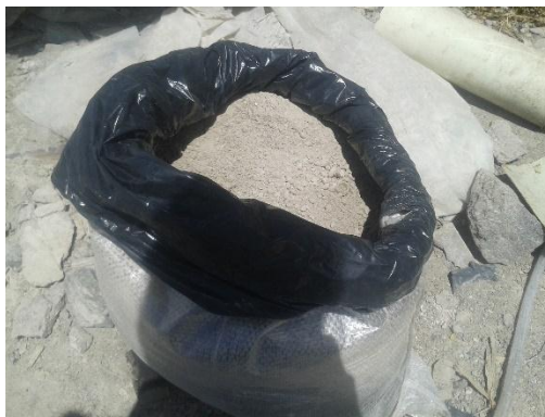
Ilustración 31.- Arena triturada después del tamizado.
