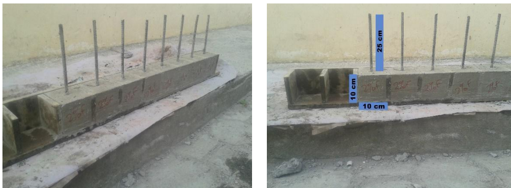
Ilustración 25.- Curado inicial de las probetas cúbicas de hormigón.
