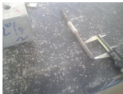
Ilustración 30.- Medición de la longitud desplazada con el calibrador pie de rey digital.
