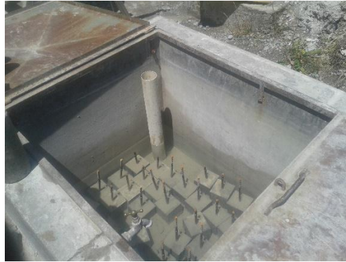
Ilustración 26.- Los especímenes ubicados en el tanque de curado.
