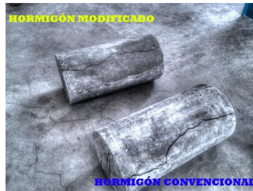
Ilustración 17.- Diferencia de fractura entre el hormigón convencional y el modificado.
