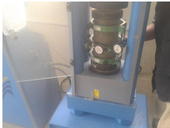
Ilustración 14.- Colocación del espécimen en el Compresómetro para luego colocar en la maquina universal.
