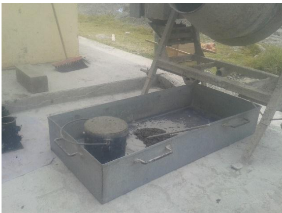
Ilustración 13.- Colocación del hormigón en el recipiente de medición y pesaje del mismo.
