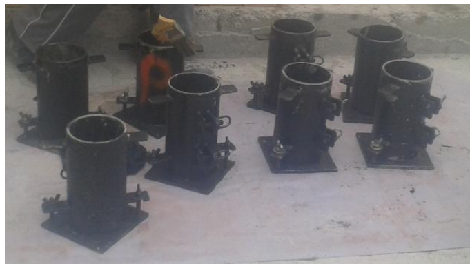
Ilustración 35.- Moldes Cilíndricos para probetas de Hormigón de 10 x 20 cm.
