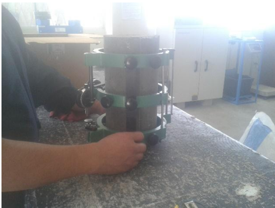
Ilustración 14.- Colocación del espécimen en el Compresómetro para luego colocar en la maquina universal.
