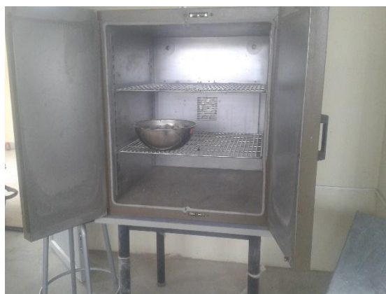
Ilustración 9.- Proceso para determinar el porcentaje del contenido de humedad de los áridos.
