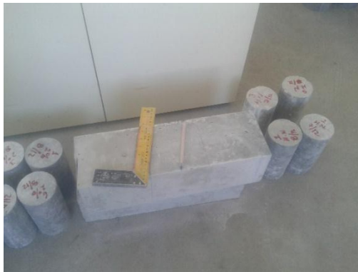
Ilustración 19.- Señalar las vigas de acuerdo a la norma INEN antes del ensayo.
