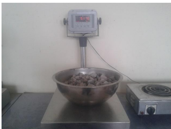
Ilustración 9.- Proceso para determinar el porcentaje del contenido de humedad de los áridos.
