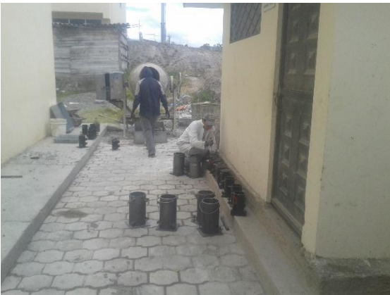
Ilustración 11.- Elaboración del hormigón y marcado de los especímenes para su identificación
