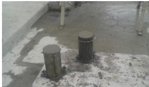
Ilustración 41.- Moldes Cilíndricos para probetas de Hormigón de 15 x 30 cm.
