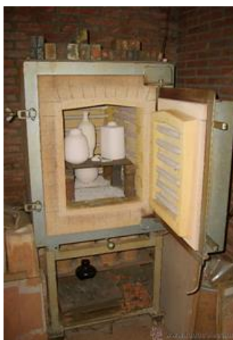
Ilustración 34: Colocación de piezas
