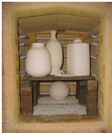
Ilustración 33: Piezas colocadas en el horno
