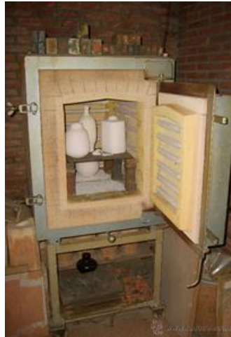
Ilustración 34: Colocación de piezas
