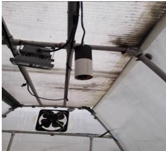
Ilustración 88: Ubicación de los sensores dentro del invernadero con la tarjeta Shiel y módulo Xbee
