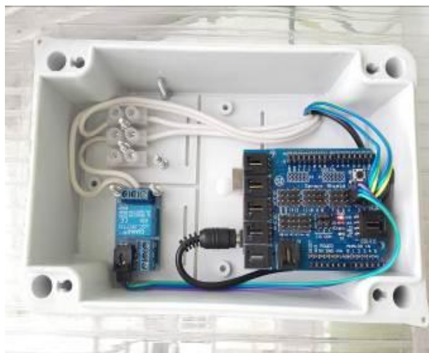
Ilustración 87: Tarjeta Arduino MEGA con la placa shield y el módulo XBee
