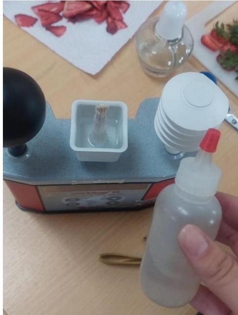
**Nota:** Se coloca agua destilada en el recipiente del medidor de estrés térmico para determinar la temperatura de bulbo húmedo.
