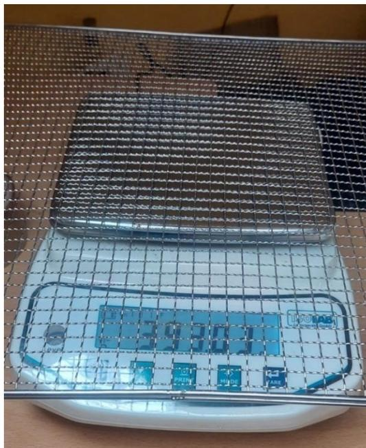
**Nota:** Se toma el peso de la bandeja para luego colocar las rebanadas de fresa (*fragaria sp*) y determinar el peso neto de la fruta.
