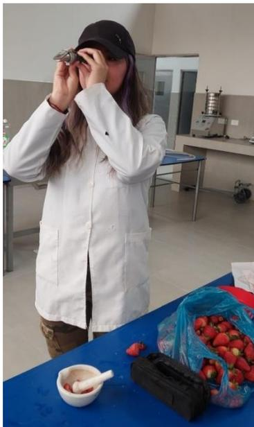
**Nota:** Se coloca una muestra de fresa (fragaria sp) en el lente del refractómetro y se observa.
