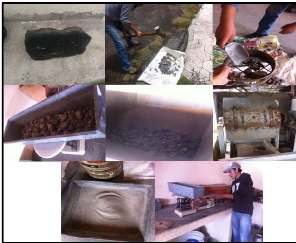
Ilustración 9. Proceso del Ensayo de Abrasión en la máquina de los Ángeles
