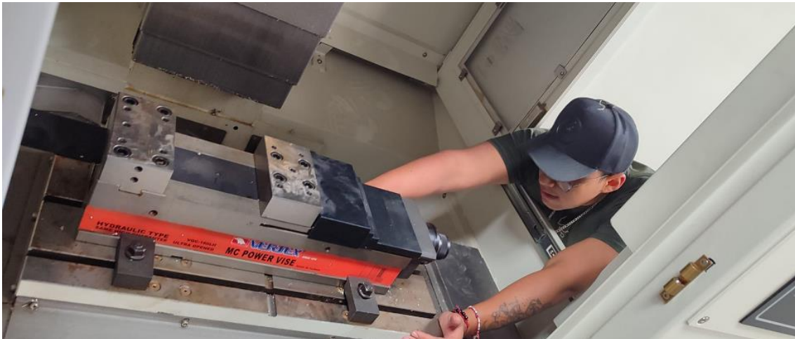
Anexo 15 Restablecimiento de las referencias de los servomotores de los ejes X, Y y Z
