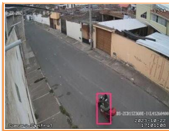
Figura 44. Detección de movimiento en Motioneye
