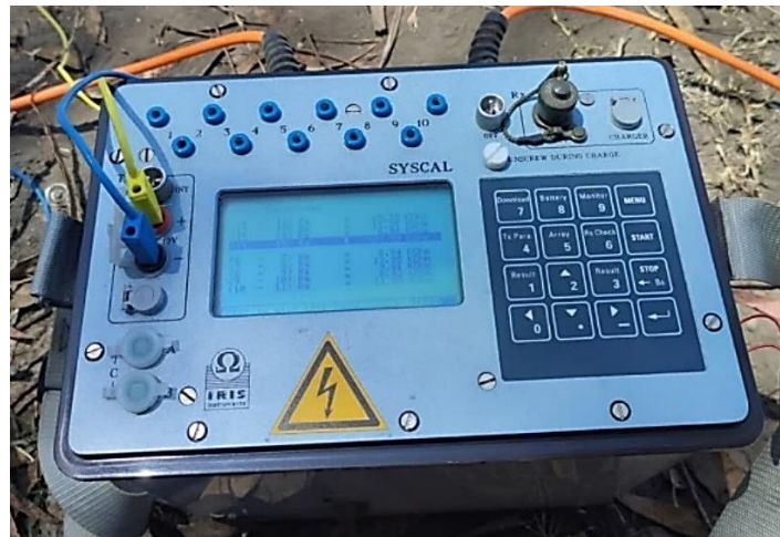
Ilustración 23 Testeo de respuesta del suelo
