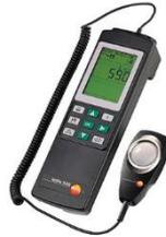
Nota. Instrumento utilizado para la medición de iluminación en la Industria Maderera “Edwin Alexander”
