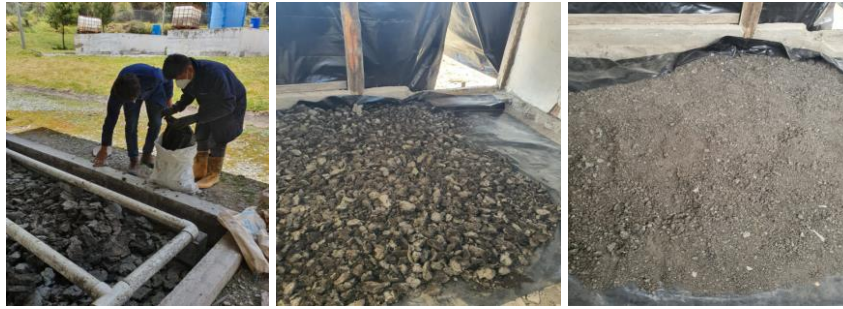
Figura 10. Proceso de Obtención de Lodo Residual, secado y tamizado.
