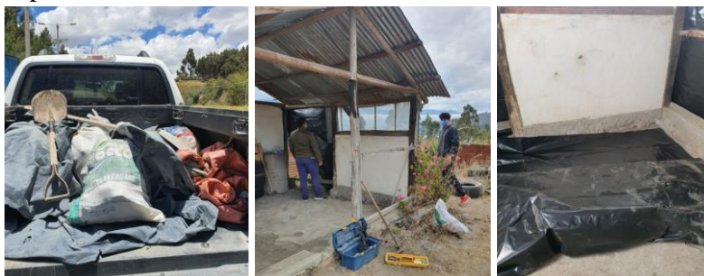
Figura 15. Movilización, almacenamiento y secado de lodo residual
