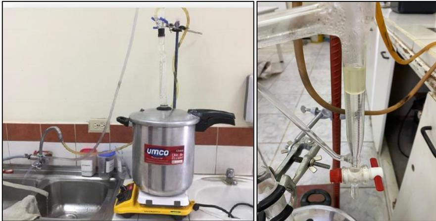
A. Método de Hidrodestilación (Trampa de Clevenger)
