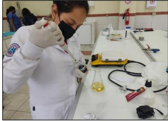
**A, B.** Preparación del AMH suplementado, añadido glucosa y azul de metileno.
